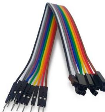
Figura 4.3 Jumpers – Fios coloridos para interligar os componentes.
